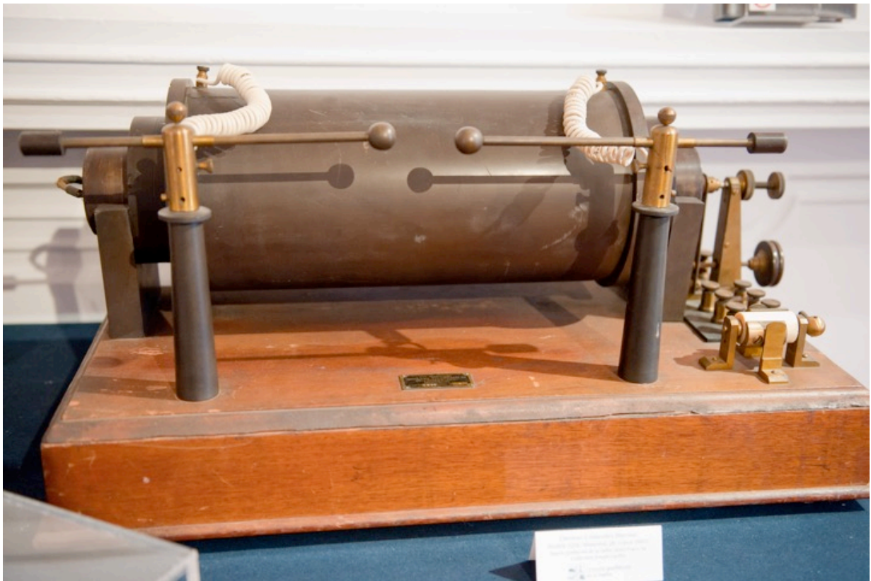
Émetteur à étincelles de marque Marconi, construit à Montréal vers 1907. (Photo : Musée de la radio)
