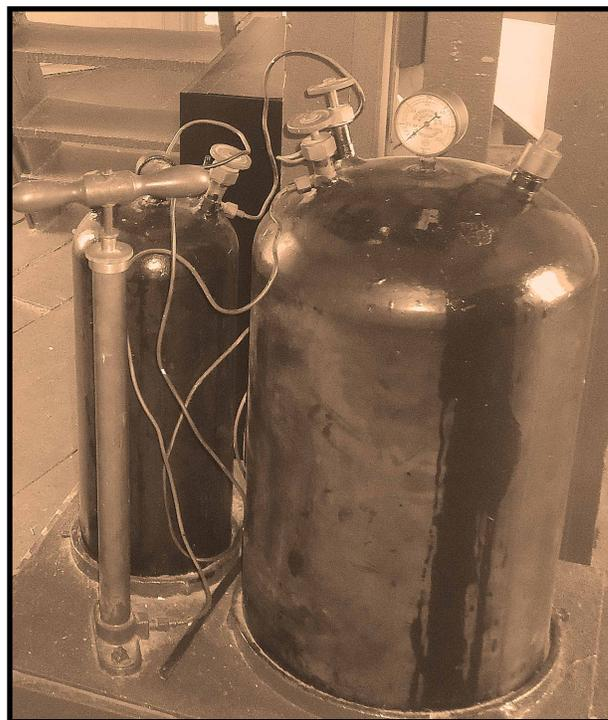
Réservoirs pour le kérosène et l'air comprimé. Coll : P. Gendron
